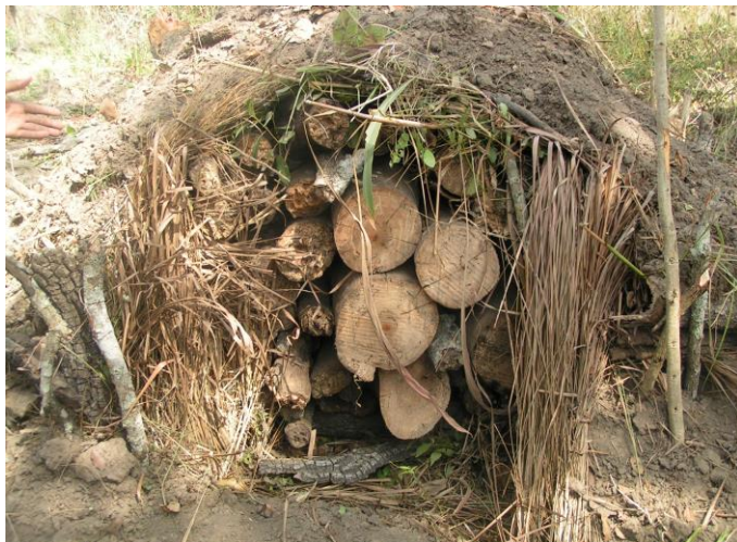
Figure 4: Constitution d'une meule traditionnelle
