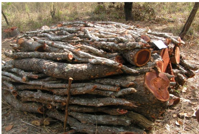
Figure 5 : Empilement des bûches d'une meule améliorée
