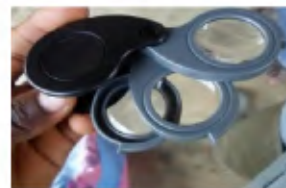
Photo 9 : Loupe manuelle à trois agrandissements superposables utilisée pour l'observation et le comptage des thrips
